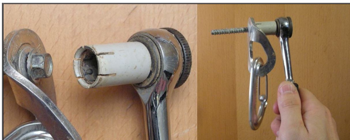
Clé à cliquet avec embout de 10 mm et système d'amarrage imperdable.
